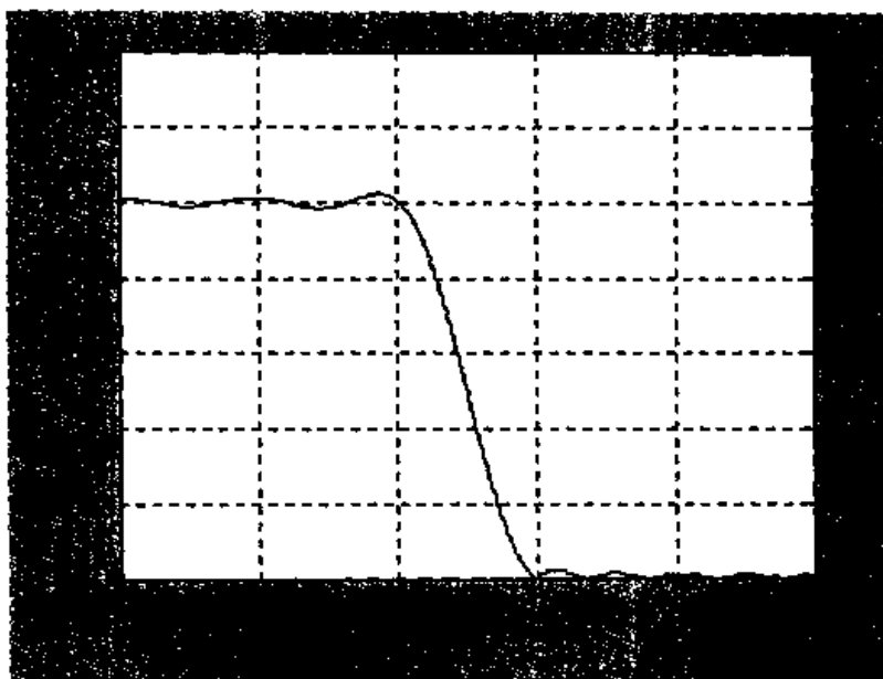
图 4.25 升余弦 FIR 滤波器幅频图
